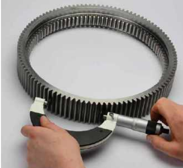
Abb. 1 – Zahnweitenmessung bei Außenverzahnung
