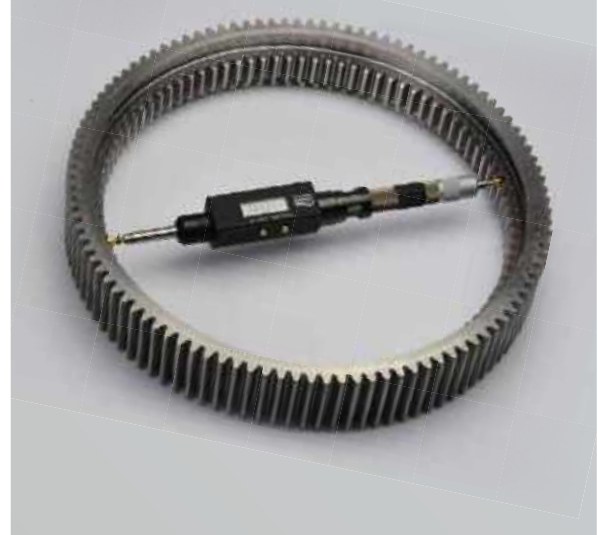
Abb. 2 – Messung des diametralen Zweikugelmaßes bei Innenverzahnung
